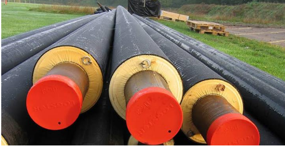
Şekil 31. Ön izolasyonlu Boruların Üzerindeki Kaçak İzleme Kabloları [6]
