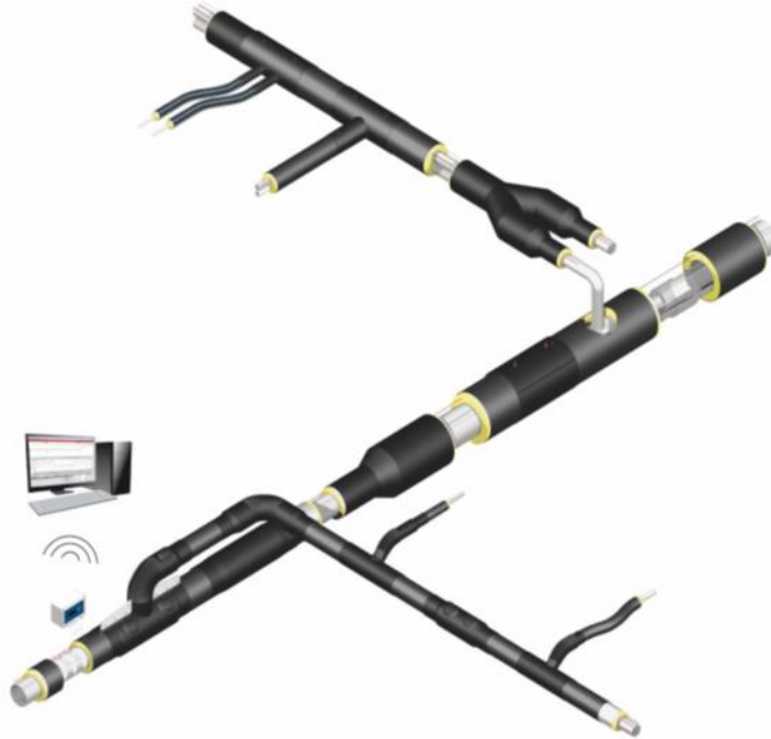
Şekil 32. Ön İzolasyonlu Borularla Kaçak İzleme [6]
